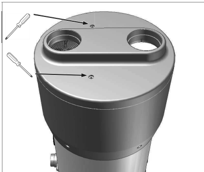
Fig. 18 – Borttagning av övre kåpa
