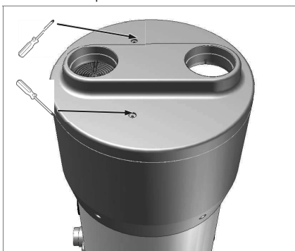
Fig. 18 – Verwijdering van het deksel bovenaan
