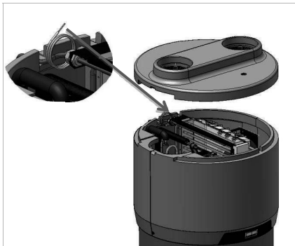
Fig. 14 – Kablar för fjärranslutning
