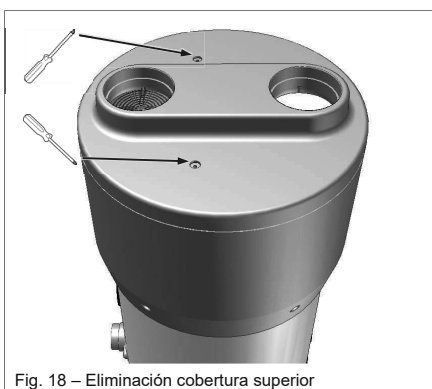
Fig. 18 – Eliminación cobertura superior
