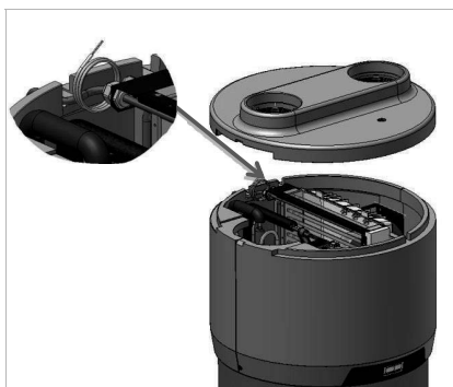
Rys. 14 – Przewody do połączenia dodatkowego
