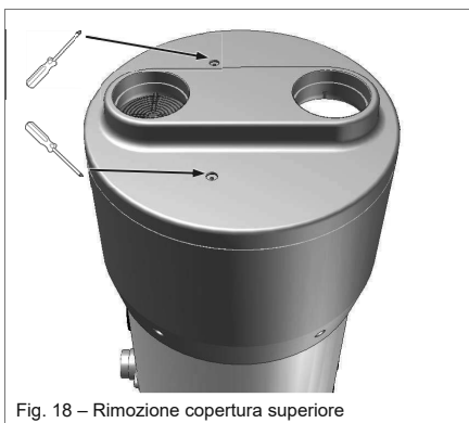
Fig. 18 – Rimozione copertura superiore
