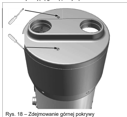
Rys. 18 – Zdejmowanie górnej pokrywy
